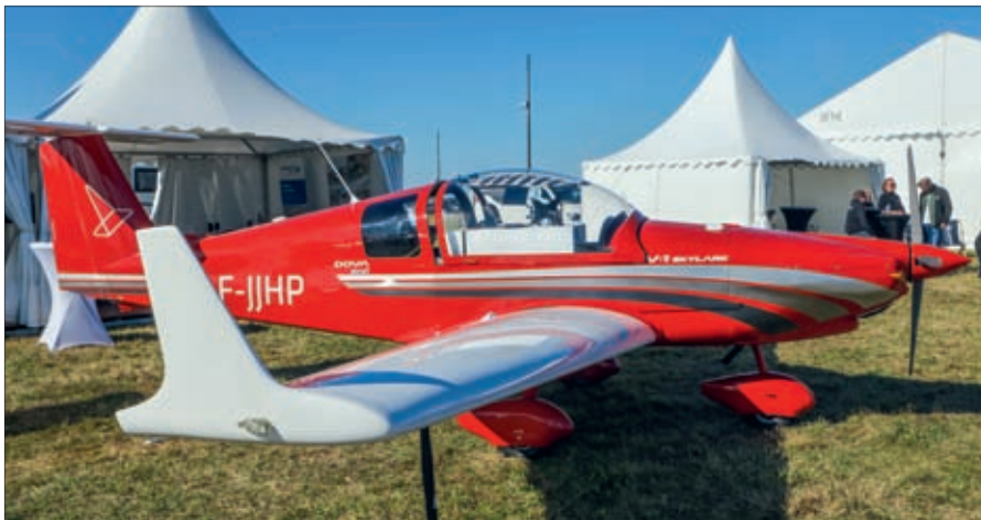
多瓦飞机公司的 Skylark 由法国多瓦飞机公司 (NorAero) 为法国制造。部件从捷克装箱运抵法国，然后在法国组装。
